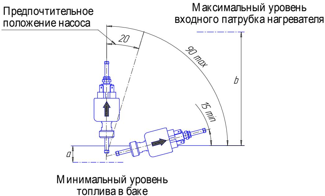
$a$  – высота всасывания до 700 мм;  $b$  – высота напора между топливным насосом и нагревателем, до 1500 мм.
