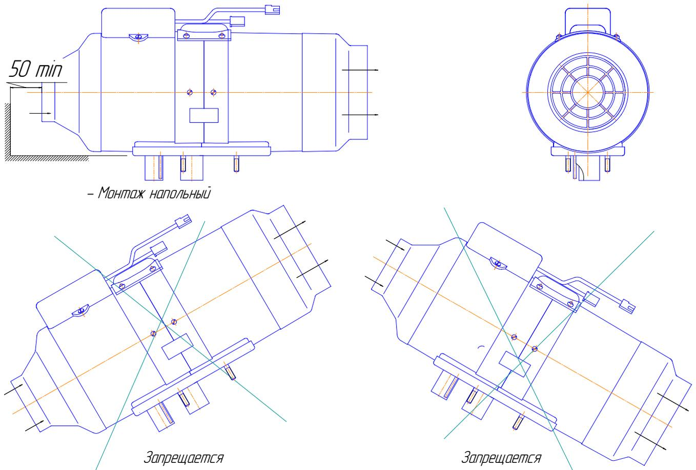
Рис. 5 – Установка нагревателя
