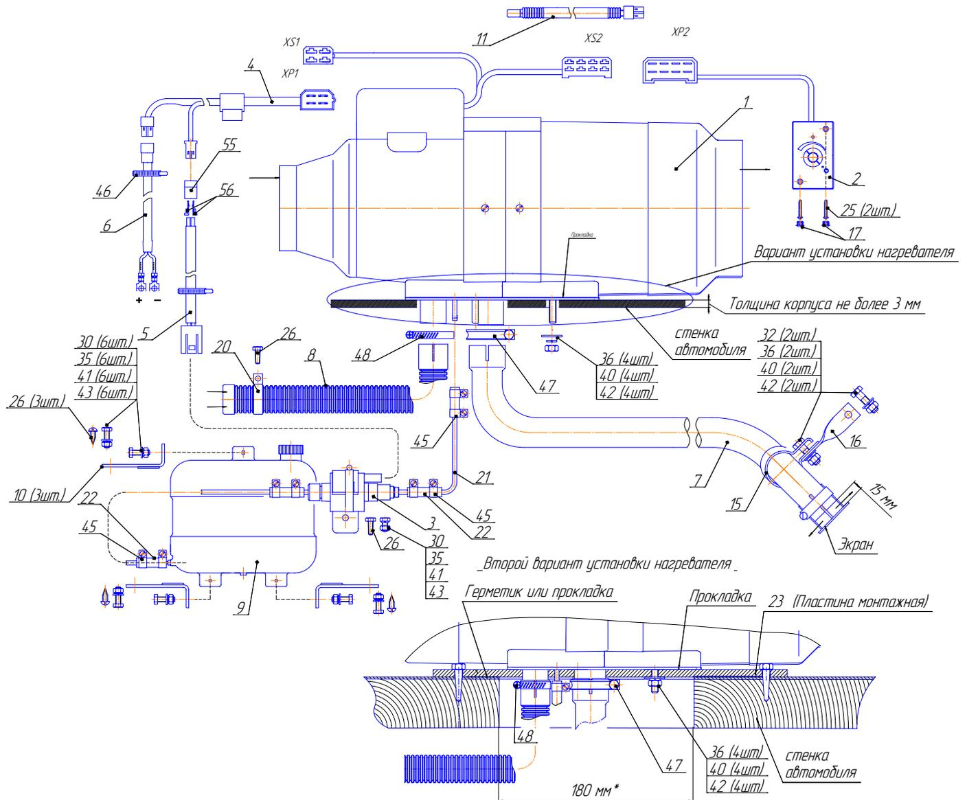
Рис 4 – Схема соединений основных узлов и деталей отопителя
